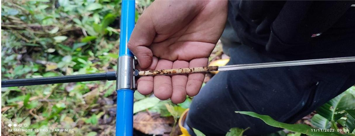
Una vez retirada la muestra se coloca en un soporte de madera teniendo en cuenta la dirección en la que fue extraída, luego se la sujeta al soporte fuertemente con cinta adhesiva cada 5 cm para evitar torceduras naturales (Figura 10).
