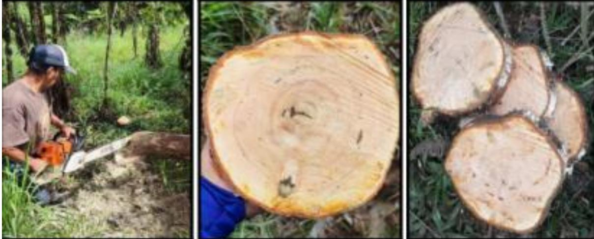
Una vez obtenidas las muestras, en este caso las trozas, se procedió a cubrir las partes transversales con parafina. Este procedimiento se llevó a cabo con el fin de preservar los niveles de humedad de cada muestra. Posteriormente, las trozas tratadas fueron trasladadas a un entorno adecuado para su mantenimiento, con el propósito de continuar con el proceso correspondiente (Figura 12).
