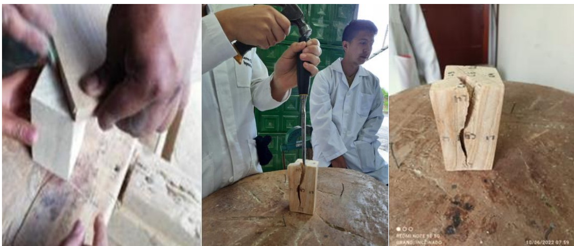
Figura 18. Identificación del tipo de grano de la madera.
