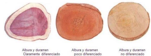
Figura 14. Transición de duramen a albura
