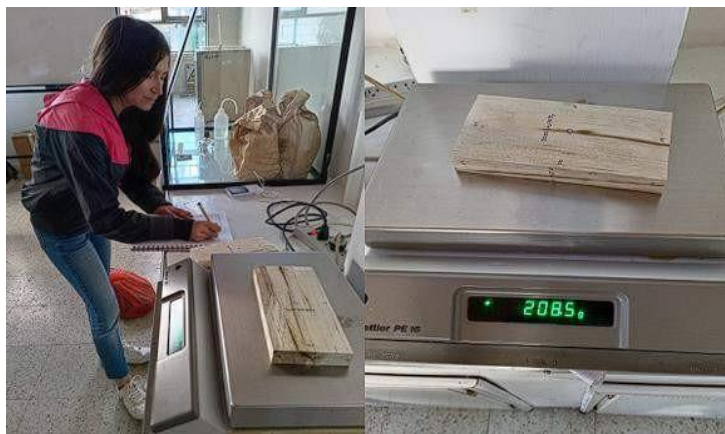
Figura 11. Pesaje de las probetas de madera.
