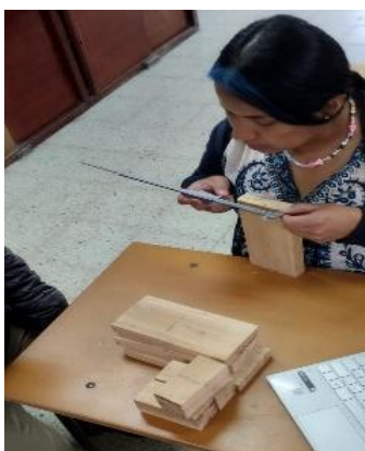
Figura 10. Medición de las probetas de madera.
