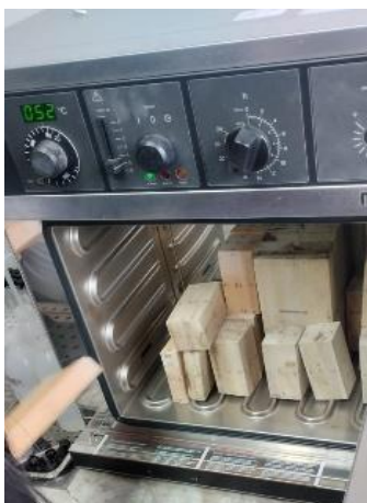
Figura 12. Secado de las probetas en la estufa.
