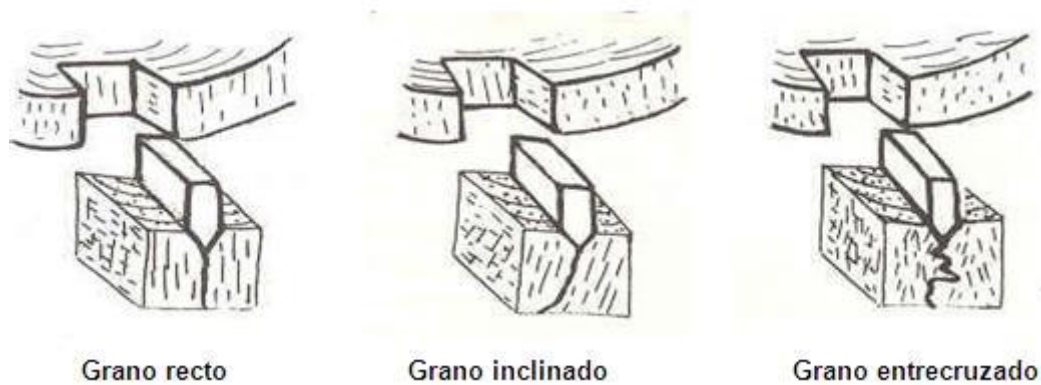
Figura 19. Clases de grano de la madera.
