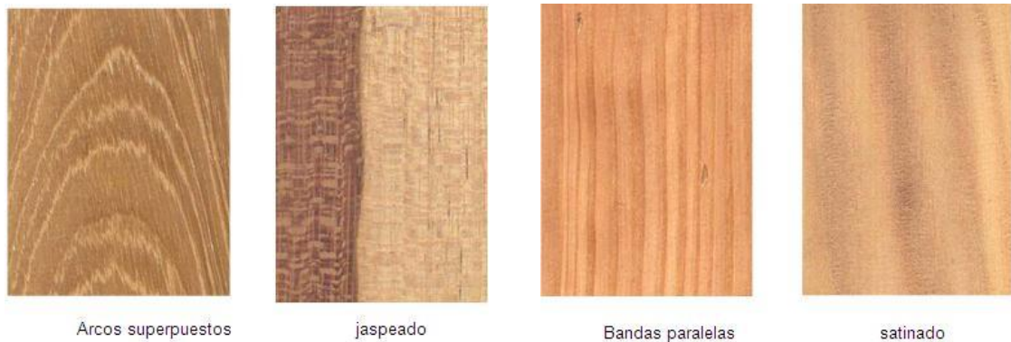
Figura 17. Clases de veteado de la madera.
