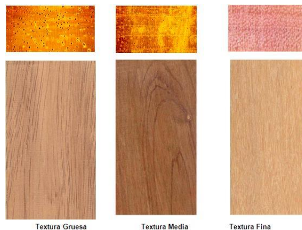
Figura 16. Clases de textura de la madera.
