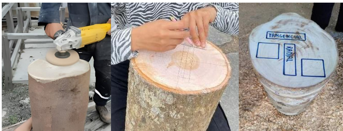
Figura 4. Trazo de las probetas.
