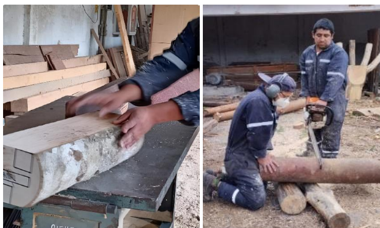
Figura 5. Corte de las probetas de madera.
