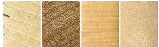
Figura 13. Tipos de anillos de crecimiento
