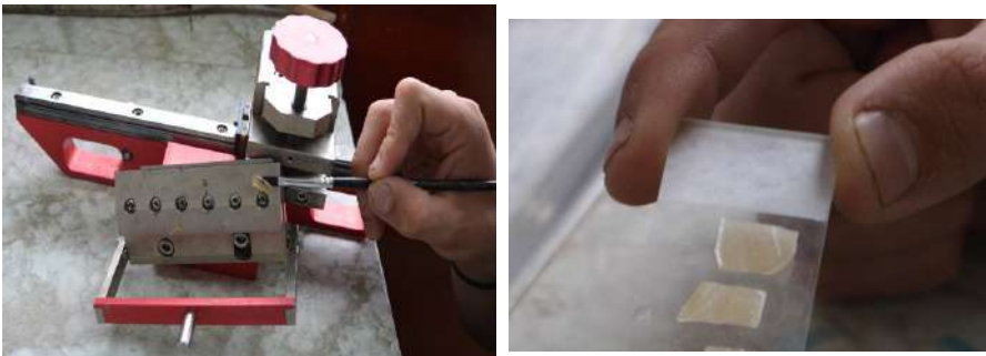
Figura 6. Ubicación del corte de madera entre un porta y cubre objetos, con la ayuda de un pincel.
