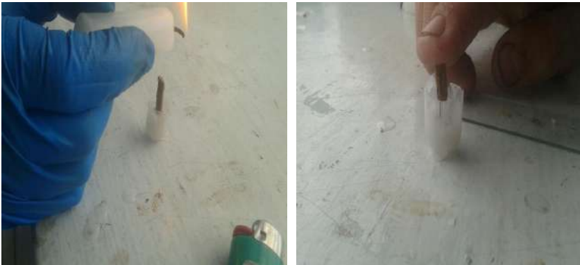
Figura 12. Colocación (Izq.) y fijación (Der.) de la muestra en el centro del molde.
