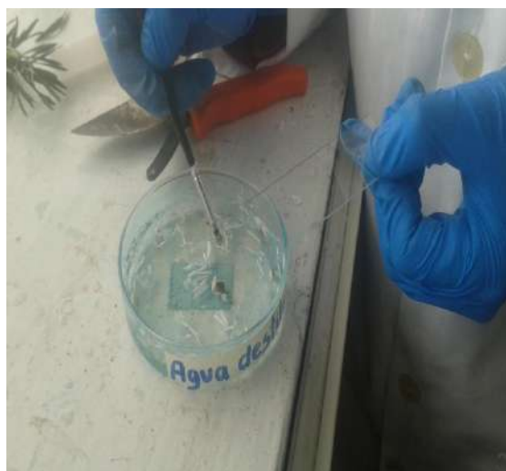
Figura 19. Selección, montaje y etiquetado de las finas láminas de madera en sus respectivos portaobjetos.
