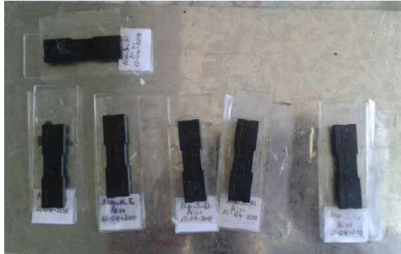
Figura 30. Muestras montadas en una placa metálica y presionadas con imanes.
