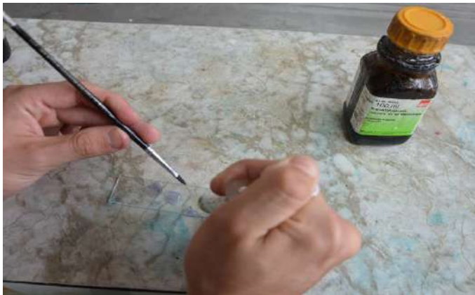
Figura 27. Colocación de Bálsamo de Canadá con ayuda de una jeringa.
