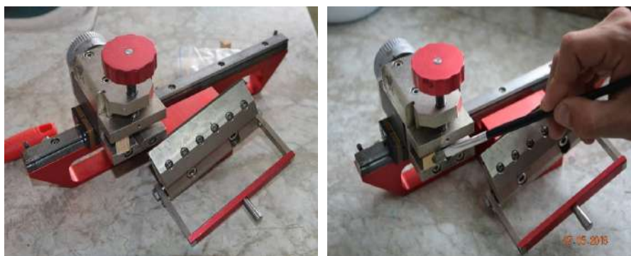
Figura 4. Instalación del cubo de madera en el micrótopo, e hidratación del plano a cortar.
