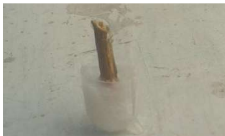
Figura 13. Reposo de 10 a 15min para la solidificación de la parafina.
