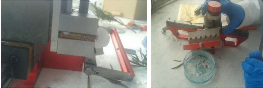
Figura 16. Ubicación de la muestra en el micrótopo.
