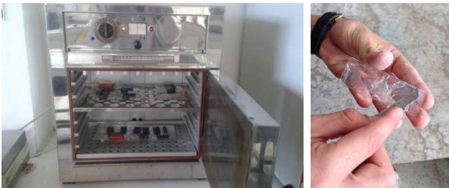
Figura 31. Secado y limpieza de muestras. Las muestras son colocadas en una estufa durante 24 horas a 60° C (Izquierda), y luego raspadas para quitar el exceso de Bálsamo de Canadá sobre los cubreobjetos (Derecha).
