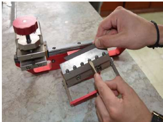
Figura 2. Colocación de la cuchilla en el micrótomos.
