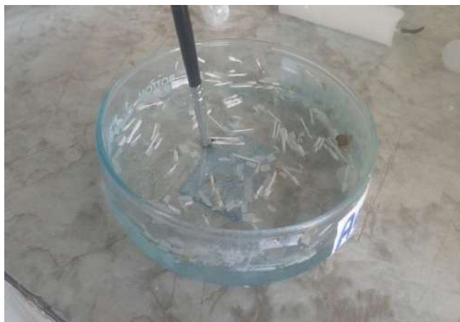
Figura 18. Separación de láminas de madera de la parafina.
