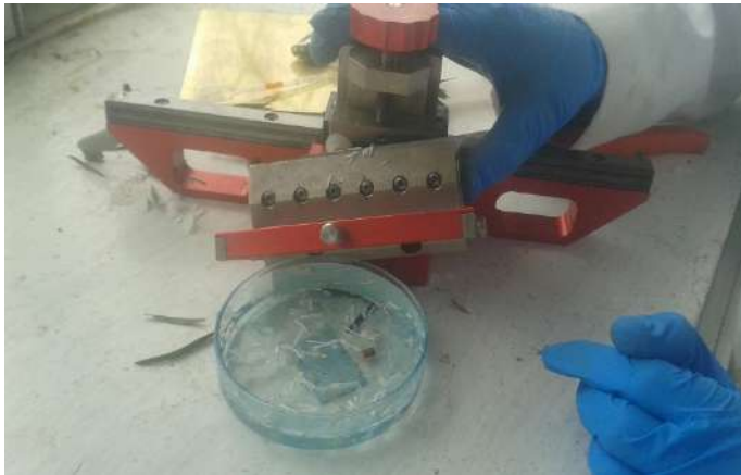
Figura 17. Corte de finas láminas de madera de 2-5 \mu\text{m} .
