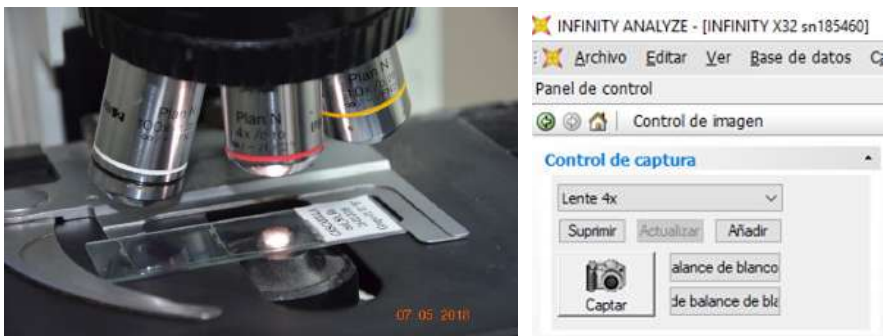
Figura 34. Verificación del número de lente del microscopio (Izquierda) con el número del lente en el software (Derecha).
