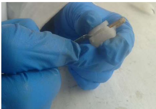
Figura 14. Extracción de la muestra con parafina desde su molde.
