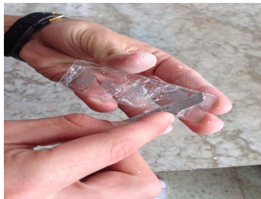
Figura 31. Secado y limpieza de muestras. Las muestras son colocadas en una estufa durante 24 horas a 60° C (Izquierda), y luego raspadas para quitar el exceso de Bálsamo de Canadá sobre los cubreobjetos (Derecha).
