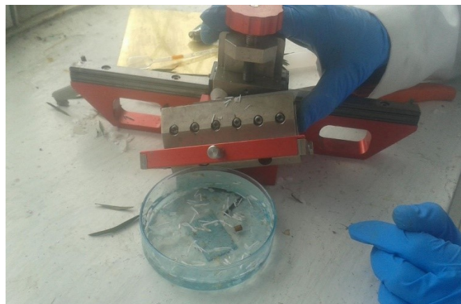
Figura 17. Corte de finas láminas de madera de 2-5 \mu\text{m} .
