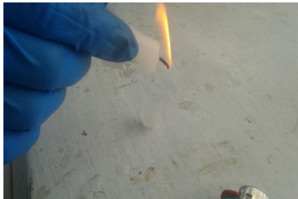
Figura 11. Relleno de 1 a 1,5cm de parafina en el molde.
