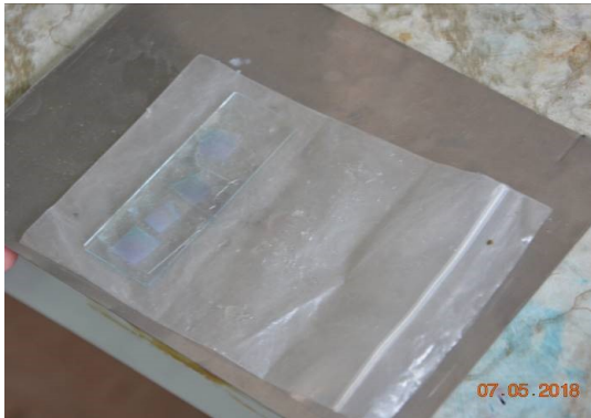
Figura 29. Colocación de plástico resistente al calor.
