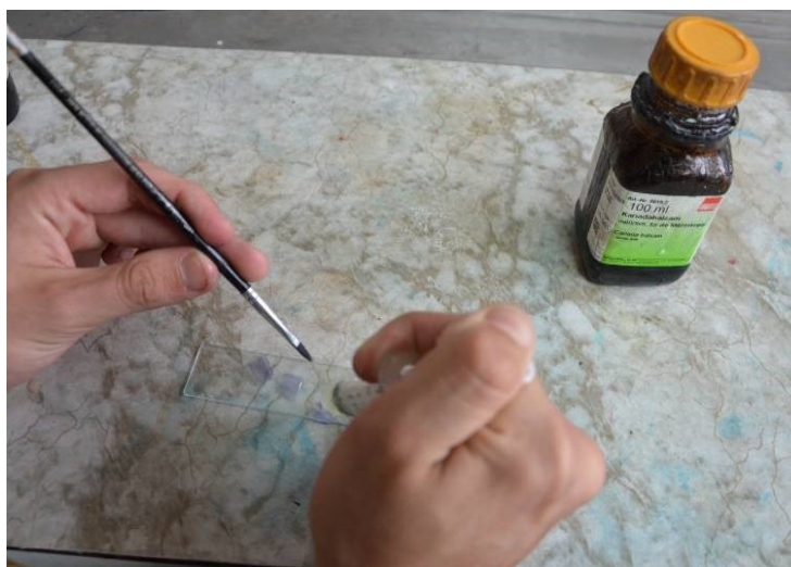
Figura 27. Colocación de Bálsamo de Canadá con ayuda de una jeringa.
